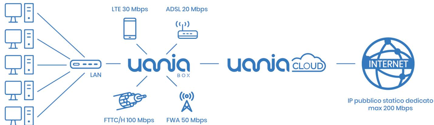
Le connettività del cliente, anche eterogenee per tecnologia e fornitore, vengono collegate fisicamente sulle interface WAN di UaniaBox.
