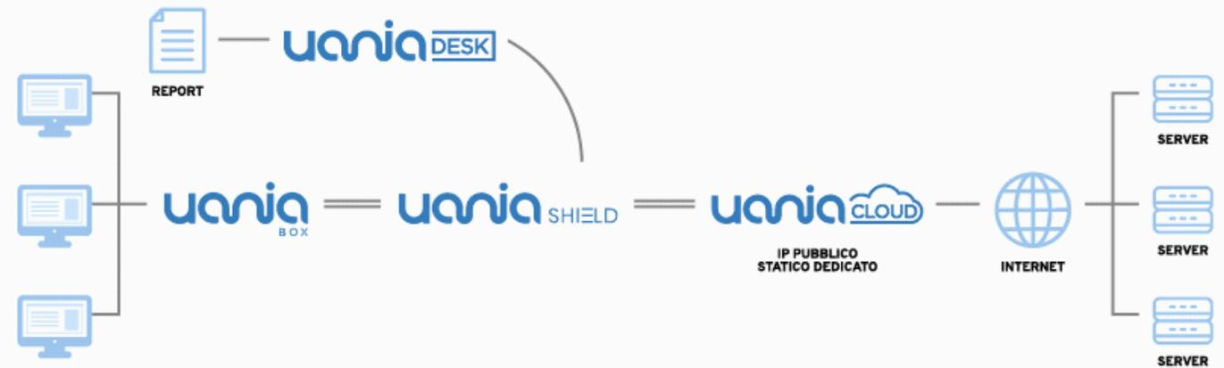
Il traffico aggregato e ridondato dal cliente viene filtrato in tempo reale attraverso un cluster di firewall UTM posizionato nel datacenter di Uania.
